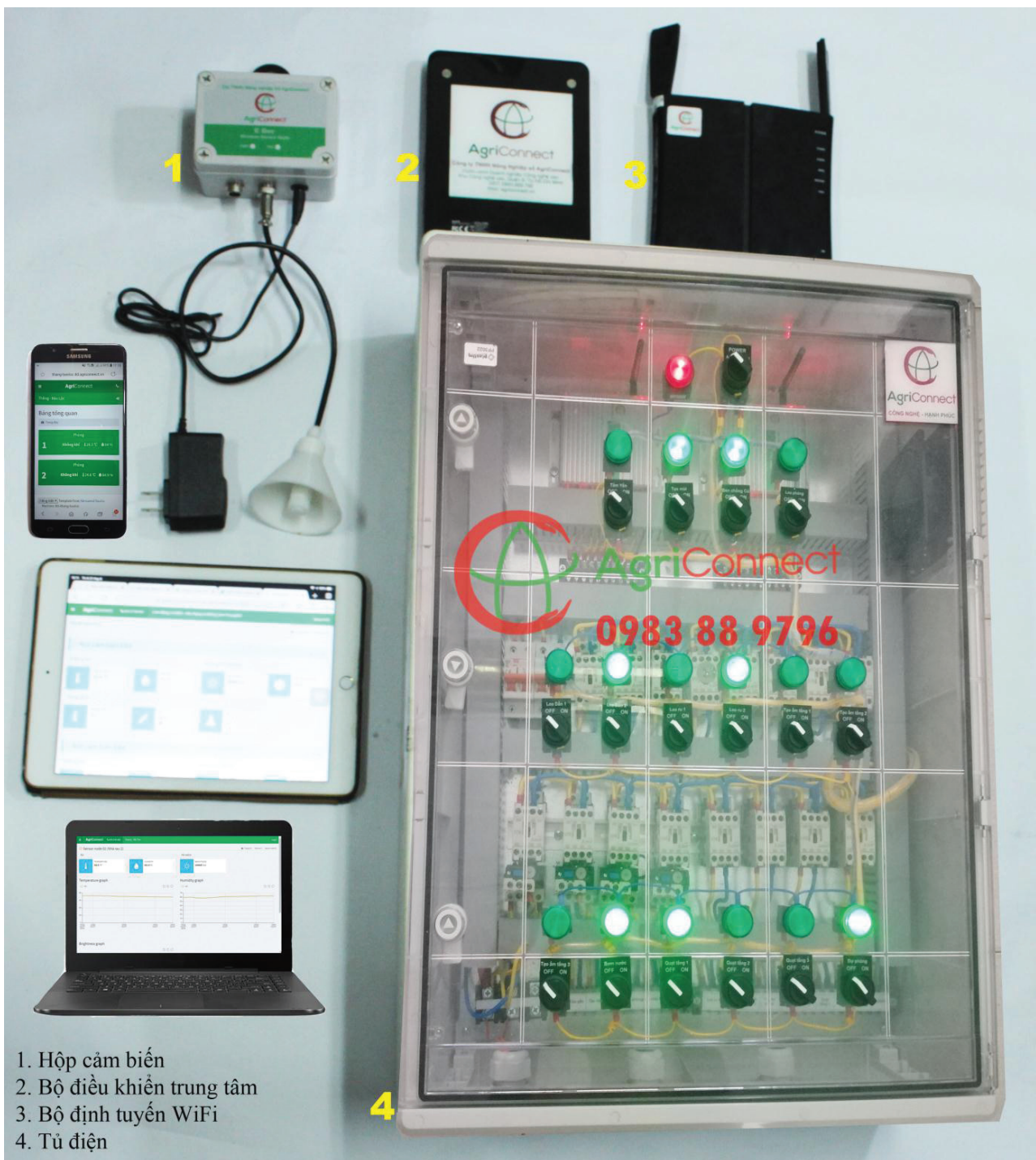
Hệ thống IoT kiểm soát môi trường cho trồng nấm rơm
